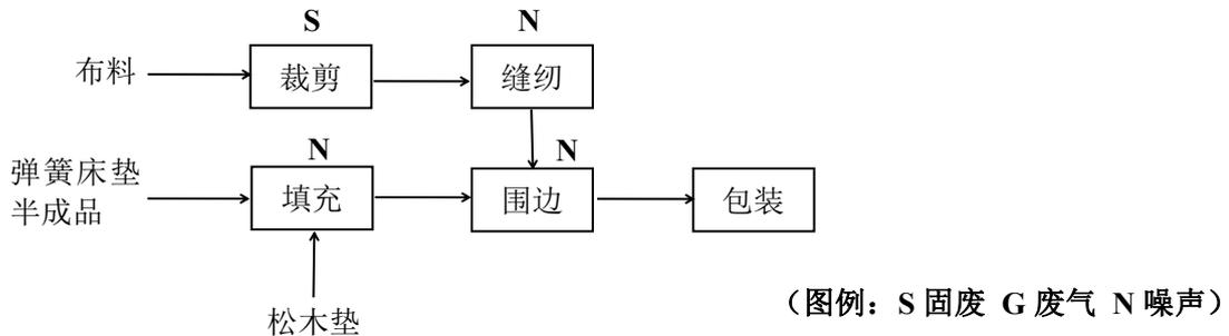
图 3 生产工艺流程及排污节点图
