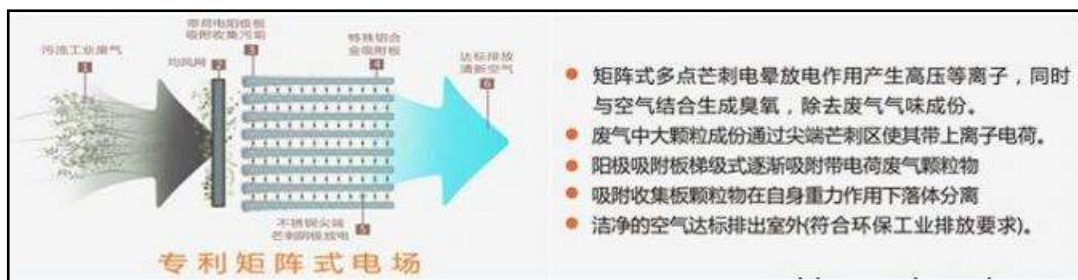
图 6.1-2 低温等离子净化有机废气处理原理图
